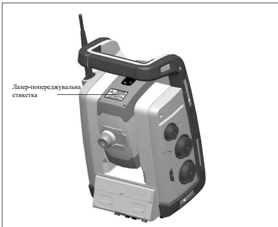
Малюнок 3.33 Розташування попереджувальної етикетки лазерного вказівника на тахеометрі Trimble RTS серії DR PLUS
