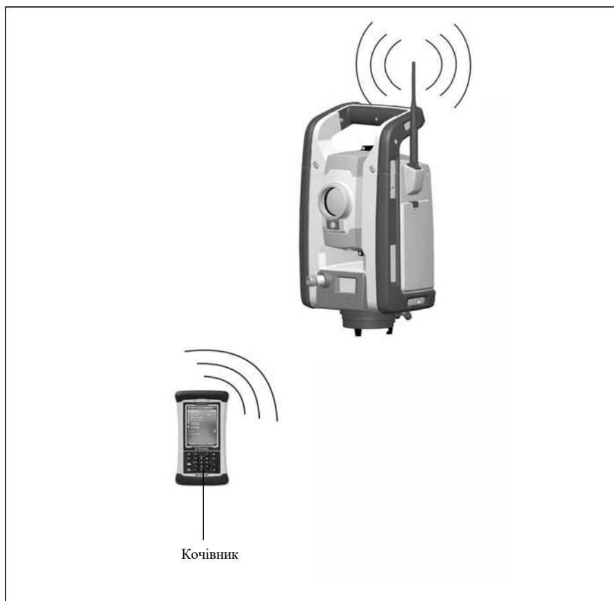
Малюнок 4.52 Кочівник підключено до тахеометра серії RTS500 за допомогою WLAN
