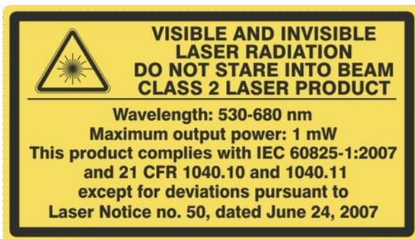
Малюнок 3.31 Трімбл Попереджувальна етикетка лазерного вказівника тахеометра RTS800 серії DR HP
