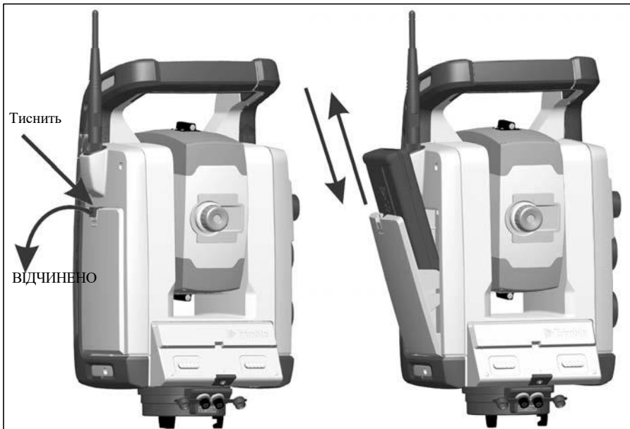
Малюнок 6.65 Видалення т а заміна внутрішньої батареї
