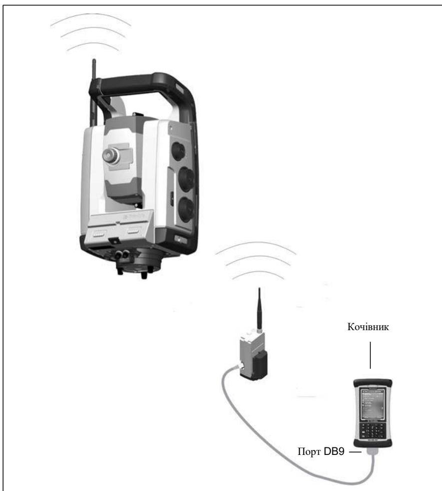
Малюнок 4.51 Nomad підключається до тахеометра RTS за допомогою зовнішнього радіомодуля 2,4 ГГц.
