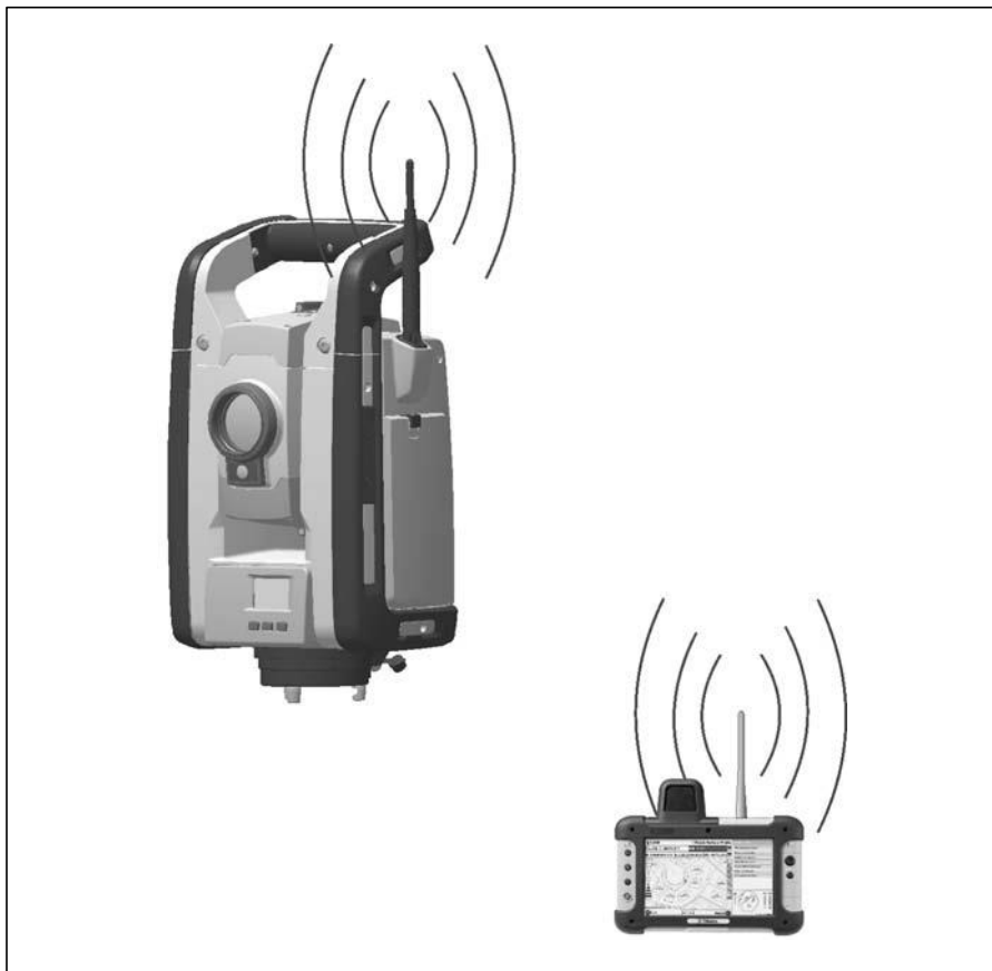
Малюнок 4.55 Планшет ПК, підключений до тахеометра серії RTS700 за допомогою додаткового радіомодуля 2,4 ГГц
