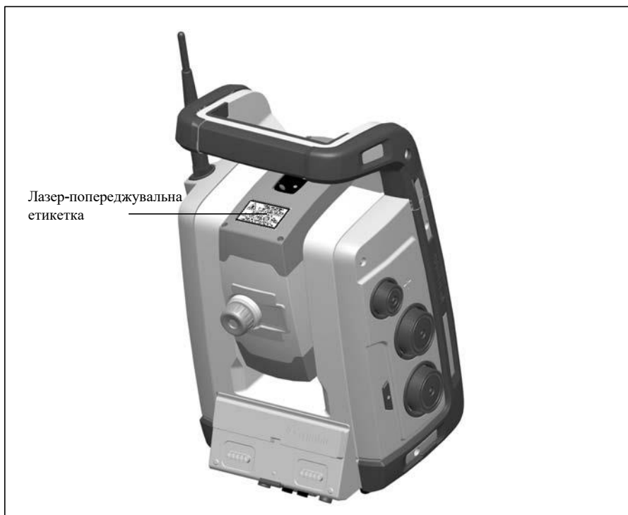
Малюнок 3.24 Розташування етикетка з попередженням про лазер на Trimble RTS серії DR
