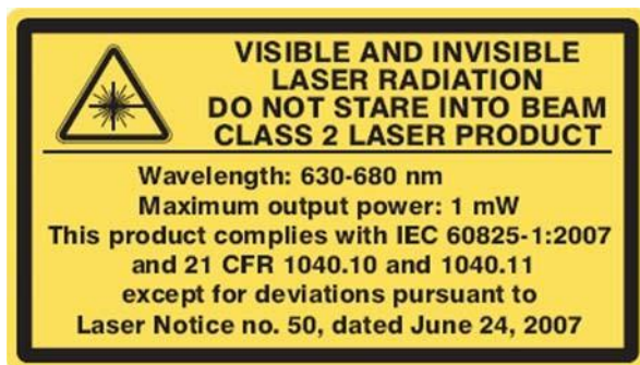
Малюнок 3.30 Трімбл Попереджувальна етикетка лазерного вказівника тахеометра RTS700 серії DR HP
