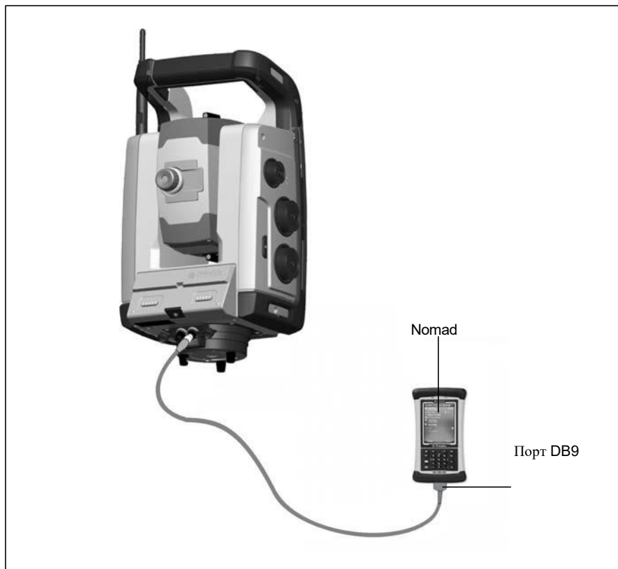
Малюнок 4.49 Кочівник підключено до тахеометра Trimble серії RTS за допомогою кабелю для сервовимірювань та вимірювань з автоблокуванням.
