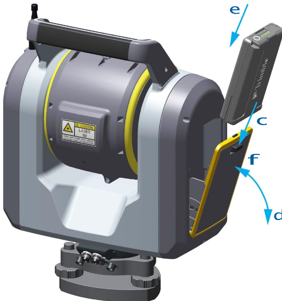
Рисунок 3.5 Як встановити та/або витягти внутрішній акумулятор
