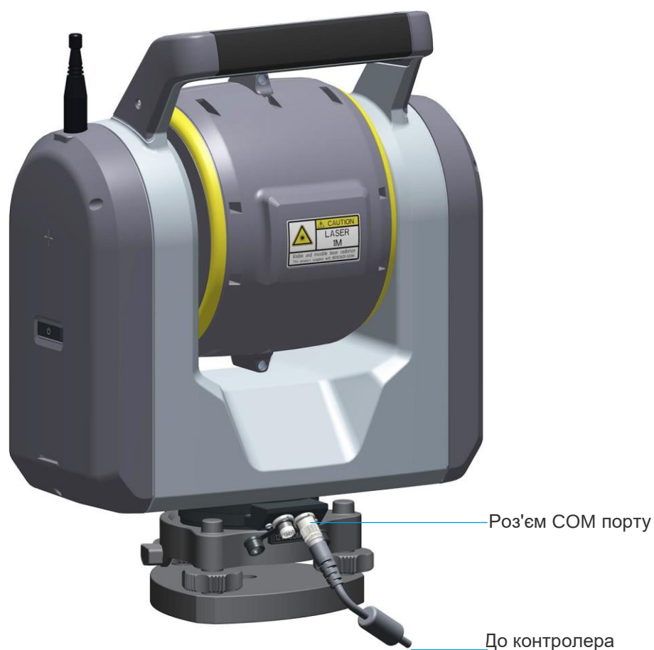
Рисунок 3.6 Інструмент, підключений до контролера за допомогою кабелю
