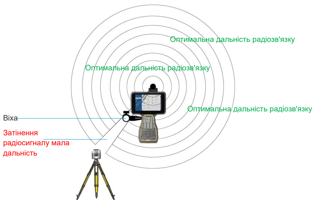
Малюнок 4.10 Устаткування затіняє радіосигнал
