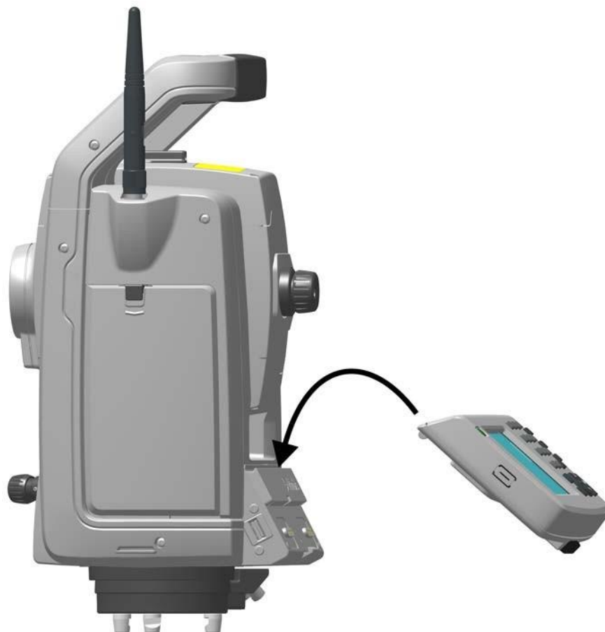
Малюнок 3.13 Установка TCU на інструмент
