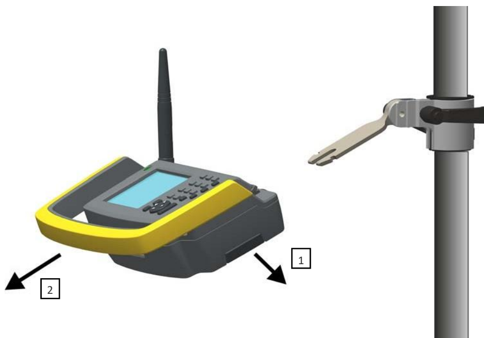
Малюнок 5.18 Від'єднання тримача Trimble Robotic із адаптера стандартної віхи
