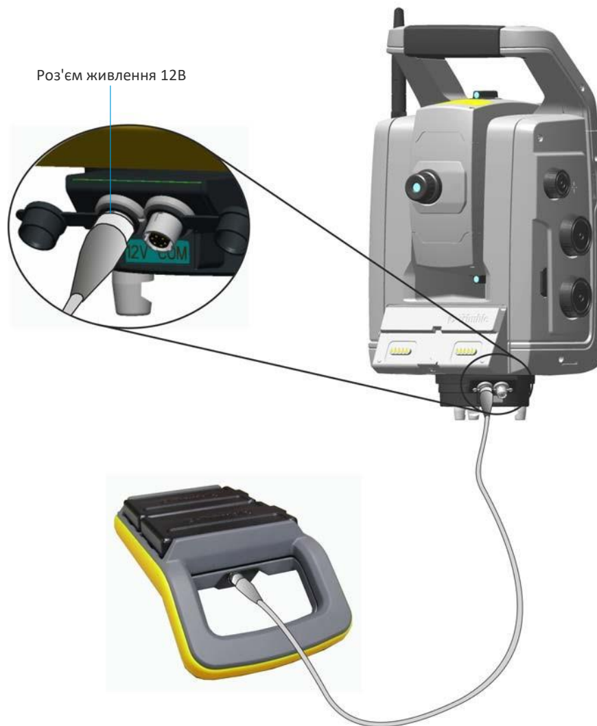
Малюнок 5.2 Підключення адаптера для кількох батарей
