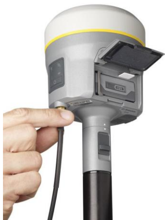
Підключення кабелю дистанційної радіоантени до приймача
